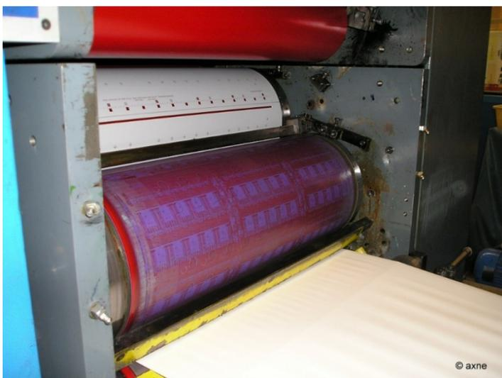
Im Anschluss folgen nacheinander die **sechs Offsetdruckwerke**. Die Plattenzylinder mit montierter Druckplatte haben einheitlich einen Umfang von ca. 663 Millimeter und die Druckplatten immer eine Breite von 530 Millimeter (Bestätigt von H. Schwea, Bundesdruckerei). Bei der Dauerserie „Blumen“ wurde durchgängig eine Papierbahnbreite von 520 Millimeter verarbeitet.
