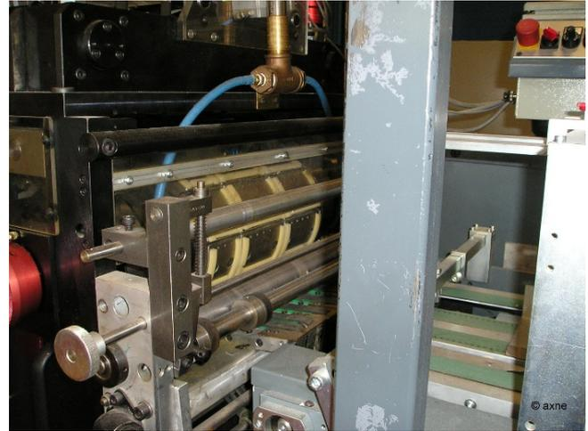
Diese beiden Bilder zeigen einen **Stanzzylinder**, der unmittelbar nach der Walzstanzeinrichtung folgt. Er dient zum Ausstanzen von ganzen Markenheftchen einschließlich der Perforation der Falzlinie. Ein anschließender Formatschnitt ist somit nicht mehr notwendig (Aussage von H. Schwea, Bundesdruckerei).
