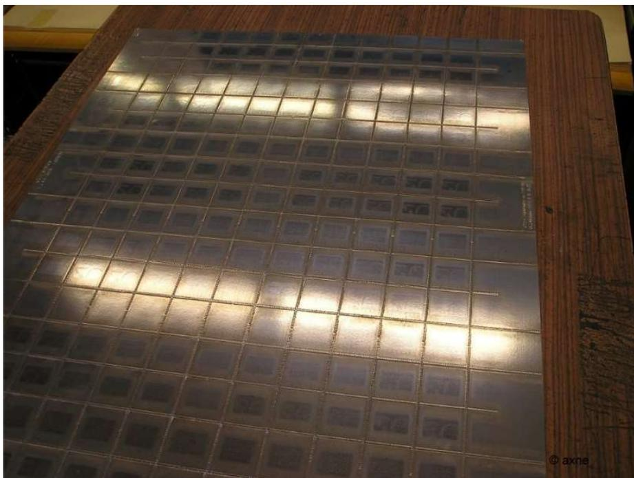
Die Herstellung eines **Pinzylinders** ist aufgrund der vielen nötigen Bohrungen zur Aufnahme der einzelnen Pins, die passgenau und mit sehr hoher Präzision ausgeführt werden müssen, sehr zeitaufwendig, teuer und in der Regel mit einer mehrmonatigen Lieferzeit verbunden. Dafür erhält man aber ein Werkzeug mit einer sehr langen Lebensdauer. Nur hin und wieder müssen Pins erneuert werden, wenn welche gebrochen sind oder nicht
