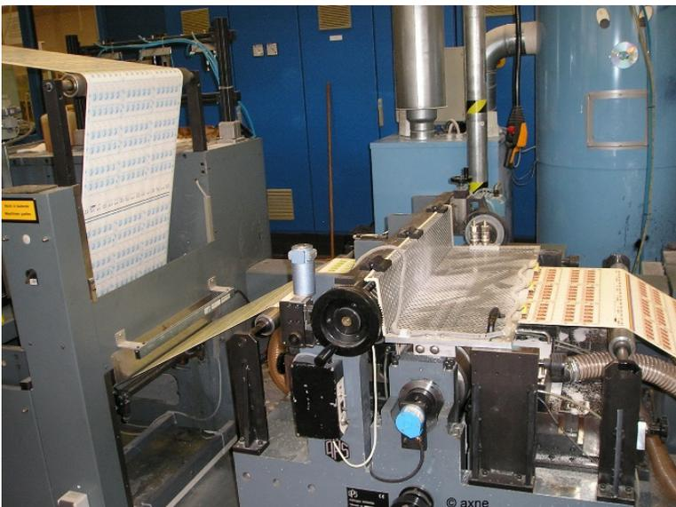
Der Stanzzylinder und die Falzeinrichtung kommen nur dann zum Einsatz, wenn die Produktion von gefalteten Markensets ansteht. Werden dagegen ungefaltete Markensets gefertigt, die in Sammlerkreisen als Folienblätter bezeichnet werden, entfällt das Falzen.
