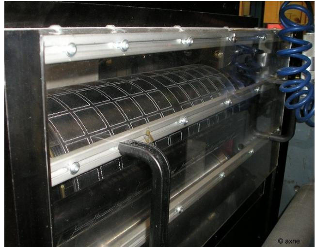
Nach diesem Prinzip können sehr feine Zahnstrukturen, ähnlich wie bei nassklebenden Postwertzeichen (14 Zähne/20 mm), realisiert werden. Ein Blick in den Briefmarkenkatalog zeigt jedoch, dass überwiegend Stanzprofile mit etwas größerem Raster, die im Bereich von 10 bis 11 Zähnen gemessen auf 20 Millimeter liegen, verwendet werden. Das könnte eventuell damit zusammenhängen, dass es bei feinen Teilungen zu Problemen beim Herauslösen der Marken aus der Matrix kommt.
