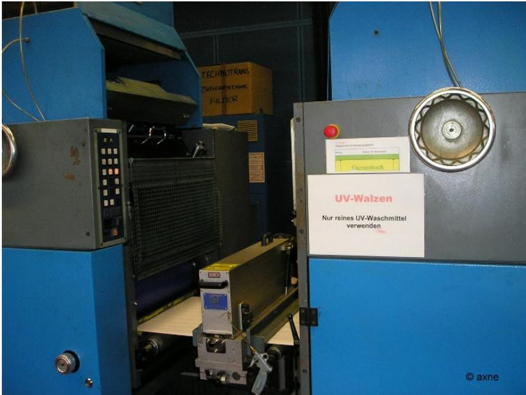
Bevor die Papierbahn zu einem nachfolgenden Druckwerk weitertransportiert wird, muss die vom davor durchlaufenen Druckwerk aufgetragene Farbe vollständig getrocknet sein. Es werden daher Einrichtungen eingesetzt, die durch Bestrahlung der frisch gedruckten Partien mit ultraviolettem Licht eine **Schnelltrocknung** der Farben bewirken. Voraussetzung hierzu ist die Verwendung von speziellen UV-Farben.
