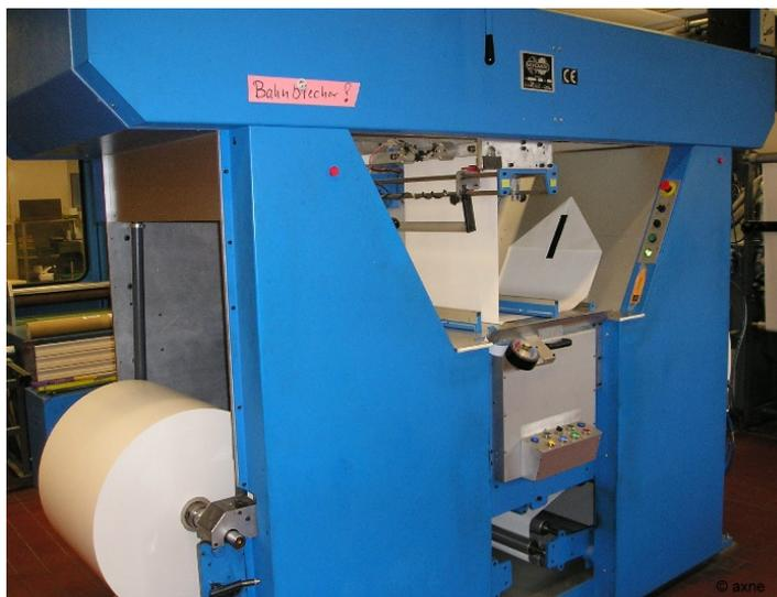
Am Anfang der Rollen-Offsetdruckmaschine befindet sich eine **Rollenwechseleinrichtung**, die an Vorder- und Rückseite jeweils eine große Papierrolle mit etwa einem Meter Durchmesser aufnehmen kann. Zunächst läuft die schon gummierte Papierbahn von der Rolle I in die
